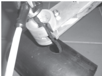
Рис. 2 Изделие «СКВ» устанавливается в «насадку сварочную»
